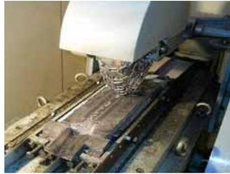
絶縁層はチェーンによる1時間の摩耗試験に耐え、更に1層補強層として同一樹脂を塗布します。
