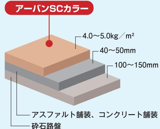
※基盤アスファルト舗装は、透水性舗装(開粒度アスコン)、非透水性舗装(密粒度アスコン)のいずれにも使用可能です。
