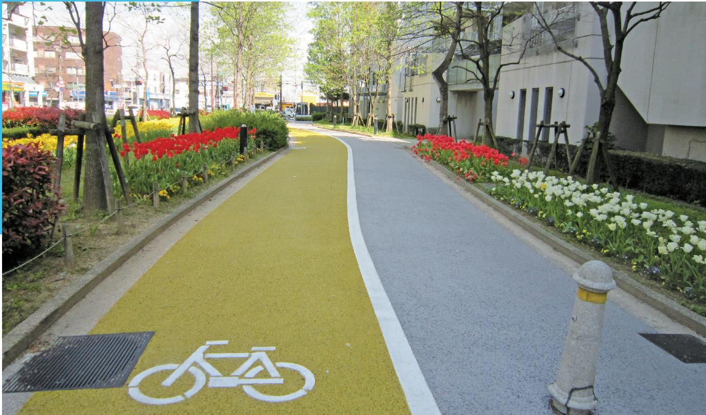
アーバンSCカラーは、主骨材にカラーサンドやカラーセラミックスサンドを用いた特殊樹脂混合物として、常温施工で薄層吹き付けするカラー舗装です。
